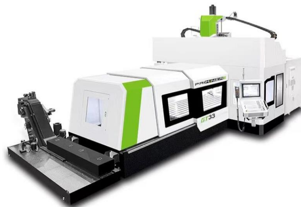
GT33 Перемещения по осям X/Y/Z: 3300/1800/800 мм
