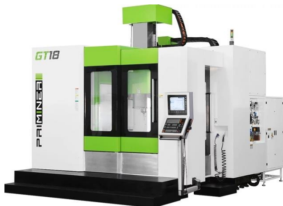
GT18 Перемещения по осям X/Y/Z: 1800/1400/800 мм
